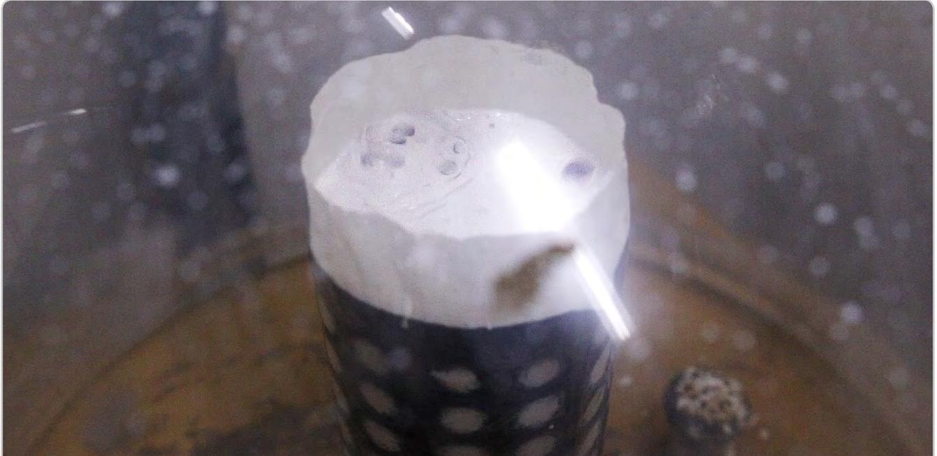
Desgasifique la matraz de colada lleno en la cámara de vacío durante 90 segundos adicionales o de acuerdo con las instrucciones del fabricante. Retire con cuidado la matraz de la cámara de inversión y permita que se ajuste en un ambiente sin vibraciones.
