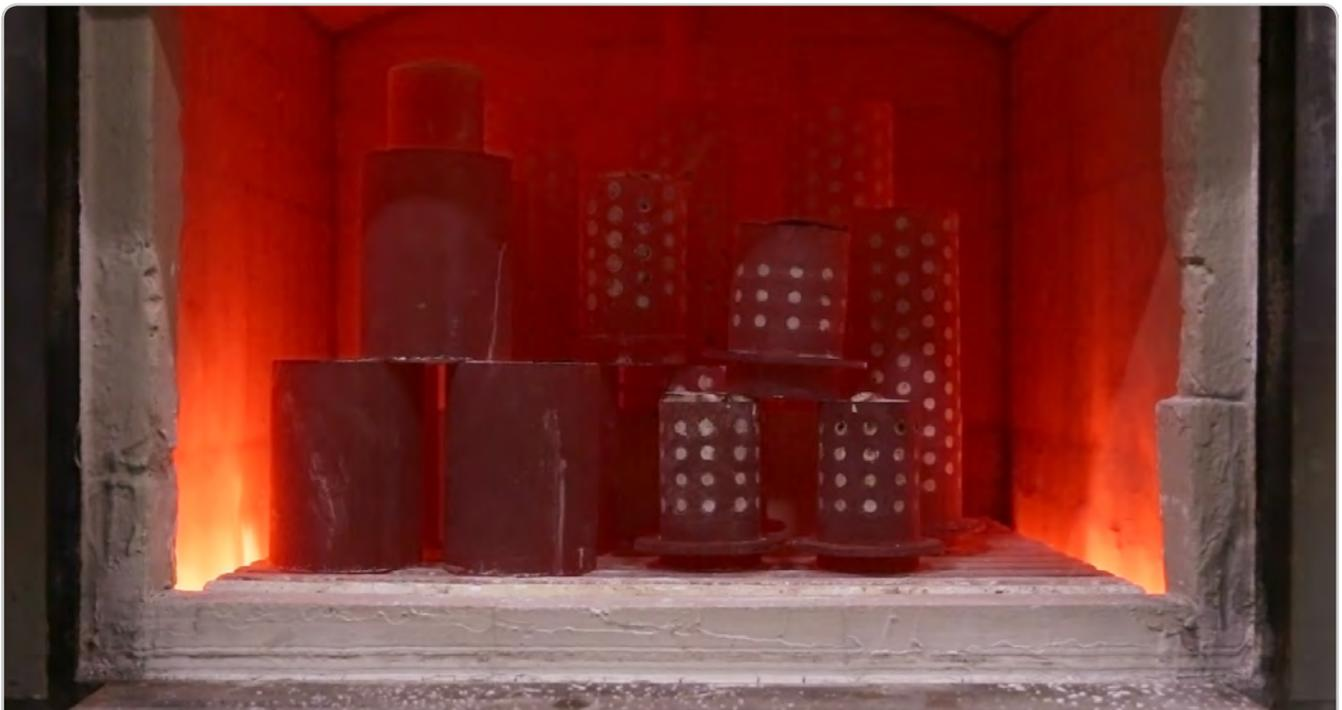
Coloque el matraz de fundición en un horno frío y caliéntelo de acuerdo con el programa de burnout que se proporciona en la página 2. Retire el molde del horno y coloque el metal.
