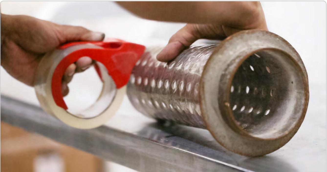
Conecte un matraz de fundición a la base del bebedero. Si el frasco está perforado, envuélvalo con cinta adhesiva transparente para contener la inversión.
