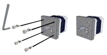
**STEP 4**: INSERT AND TIGHTEN DRIVE GEAR.
