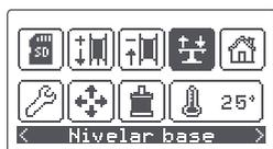
A impressora faz uma leitura no centro da base e para no primeiro ponto dianteiro esquerdo. Se o LED vermelho do sensor não acende ou se pisca, significa que a distância entre a base e o extrusor não está correta. Para a corrigir, deve rodar o manípulo serrilhado inferior que corresponde a esse ponto para mover a base no eixo Z até que o LED acenda ou deixe de piscar. O ponto estará nivelado quando a luz se mantiver fixa.
