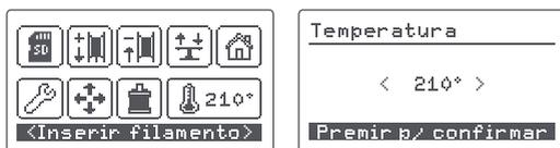
2. Terminado o procedimento de aquecimento, pode carregar o filamento através da antepara de encaixe, a peça de plástico que tapa a abertura na parte traseira da impressora. É muito importante colocar corretamente a bobina com o filamento a sair pela direita do carrete. Corte a ponta do filamento na diagonal com uma tesoura para facilitar a introdução do fio no tubo.
