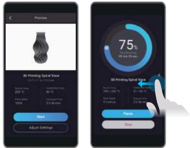
En caso de una mala adherencia, deslice hacia la izquierda en la pantalla de proceso de impresión y ajuste la compensación Z. También puede intentar nivelar la cama caliente seleccionando **Calibración**. Compruebe que la punta de la boquilla está limpia antes de calibrar la cama.
