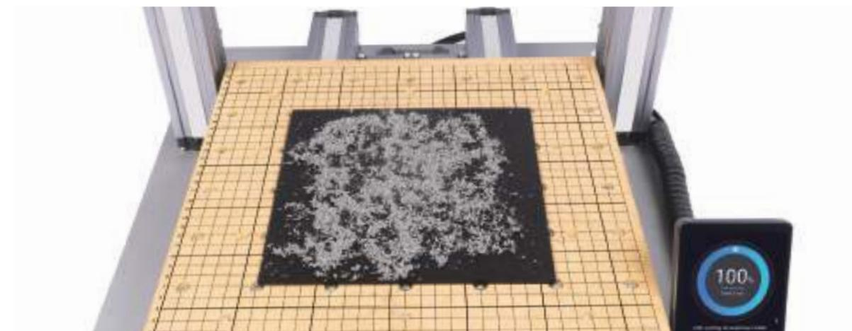
2. Limpie el trabajo acabado y la máquina con un aspirador de polvo y retire el trabajo acabado con unas pinzas de corte diagonal.
