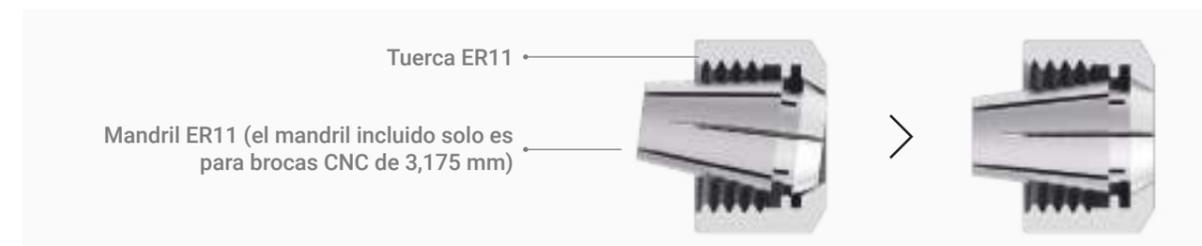
2. Colóquese las gafas de seguridad CNC. Introduzca la broca CNC en el mandril ER11 (para el modelo proporcionado se necesita una fresa de acabado plano). Siga empujando la broca CNC hasta que el extremo toque con la protección del mandril ER11.
