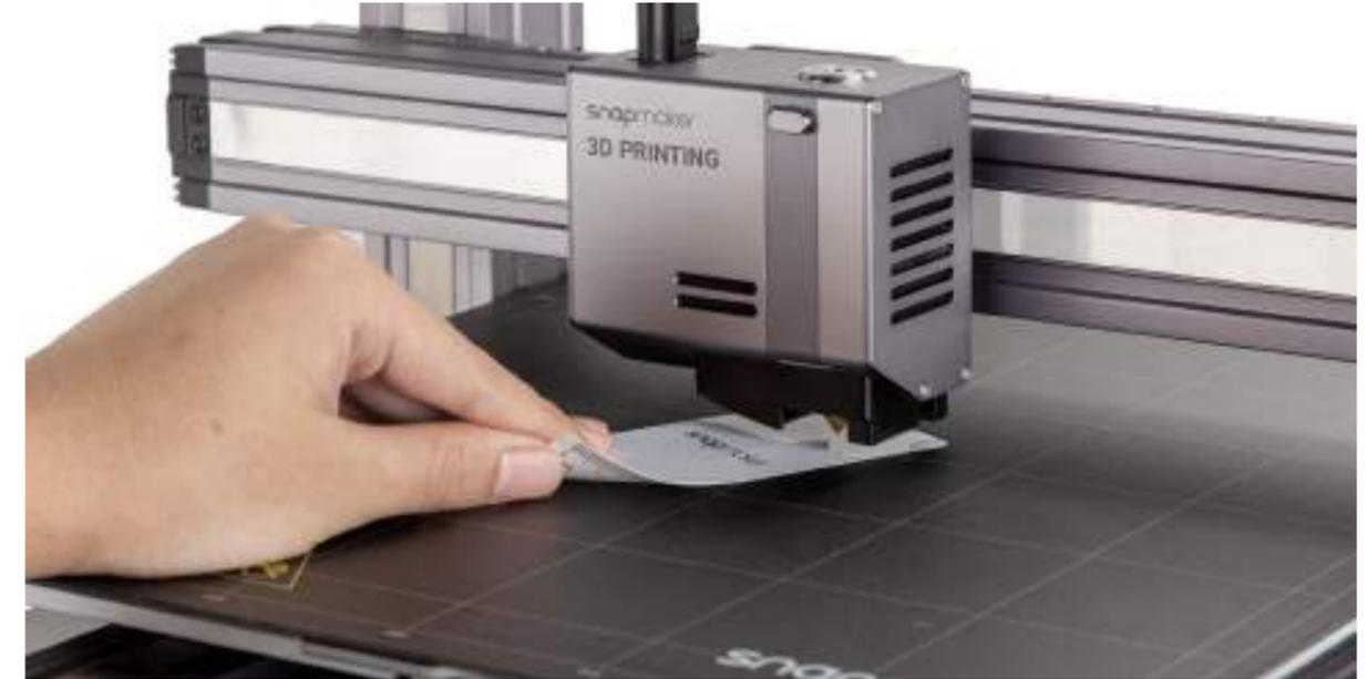
3. Siga ajustando la altura de la boquilla mediante los botones **Arriba** y **Abajo**, hasta que sienta una ligera resistencia al extraer la tarjeta de calibración, y debería arrugarse a medida que se avanza. Haga clic en Guardar para guardar la configuración de calibración.
