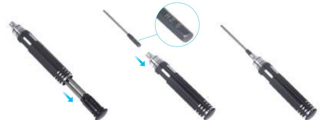
Utilice la broca H2.5 para el montaje de la máquina. Utilice las otras brocas para el mantenimiento. Antes de usar, compruebe que el soporte de la broca del tornillo se ha vuelto a colocar en el mango.
