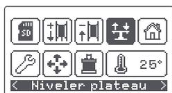
L'imprimante fait une lecture au centre du plateau et s'arrête sur le premier point avant gauche. Si la LED rouge du capteur ne s'allume pas ou clignote, cela signifie que la distance entre le plateau et l'extrudeuse est incorrecte. Pour remédier à cela, tournez sous le plateau la molette correspondant au point concerné afin de bouger le plateau sur l'axe Z jusqu'à ce que la LED s'allume ou ne clignote plus. Le nivellement du point est terminé quand le voyant rouge devient fixe.
