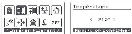
2. Une fois le processus de chauffage terminé, insérez le filament dans la pièce en plastique recouvrant l'orifice situé à l'arrière de l'imprimante. Il est très important de placer correctement la bobine et que le filament se déroule par la droite. Coupez la pointe du filament en diagonale avec des ciseaux pour faciliter son entrée par le tube.
