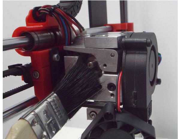
A continuación monta de nuevo el ventilador y el disipador en su sitio. Recuerda que la pegatina del ventilador va del lado del extrusor a la hora de montarlo. En caso de colocarlo al revés, el flujo de aire irá en sentido contrario. Revisalo y si te equivocas, desmonta el ventilador y colócalo bien antes de realizar una impresión.
