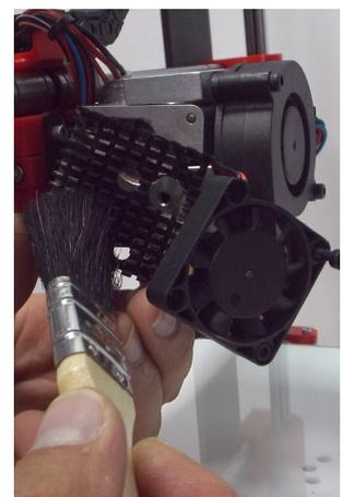
Una vez hecho esto ya puedes retirar del interior del extrusor el polvo y suciedad que se hayan podido acumular. Para hacerlo basta con pasar la brocha de dentro hacia fuera, retirando así cualquier resto.
