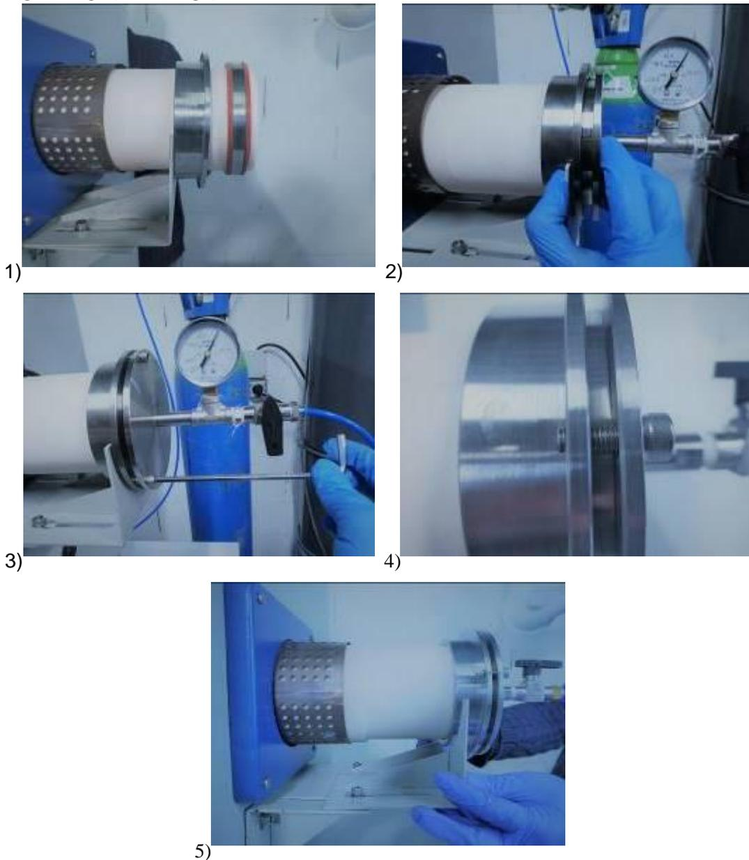
Install the left flange (outlet flange) :
