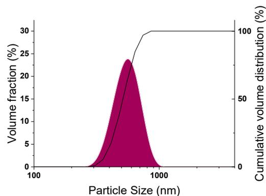
D<sub>10</sub>: 310nm D<sub>50</sub>: 503.3nm D<sub>90</sub>: 681.2nm
