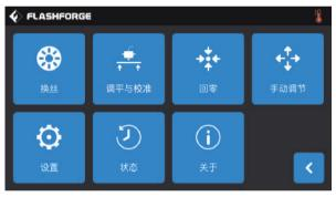
5.打印机连接电源,开机后,在触摸屏上依次点击【工具】、【手动调节】进入手动控制界面;
