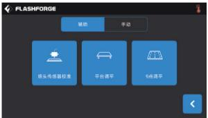
9点调平功能:在平台调平以及XY/Z轴校准后,打印平面度仍较差时,可以使用该功能进行补偿,以获得更好的平面度;
