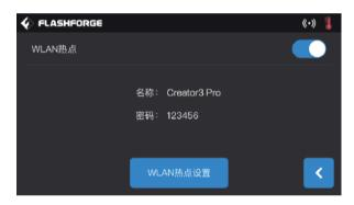
1、在设备触摸屏的主界面依次点击【工具】-【设置】-【WLAN热点】,开启设备热点。您可以自由设置热点的名称和密码。屏幕右上角出现 **◎** 图标,则表明设备已经成功开放热点。
