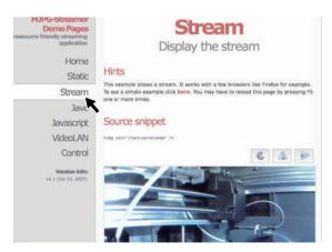
3、打开浏览器,输入并前往地址10.33.23.180:8080(示例供参考,以本地获取的IP地址为准),点击【Stream】即可查看金刚 狼3 Pro内摄像头画面。
