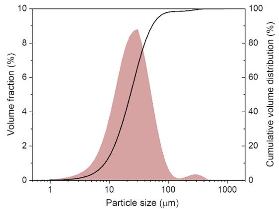
D<sub>10</sub>: 9 µm D<sub>50</sub>: 23 µm D<sub>90</sub>: 56 µm
