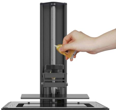
1. Si el eje Z emite ruidos de fricción durante el funcionamiento, aplique una cantidad adecuada de grasa lubricante al husillo del eje Z.
