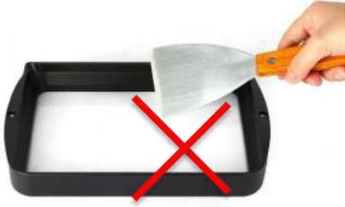
2. Eliminar la resina que quede en la película separadora cuando falle la impresión: Deje expuesta la pantalla completa durante 20 segundos y luego quite toda la capa de resina curada, lo que puede proteger eficazmente la película separadora.
