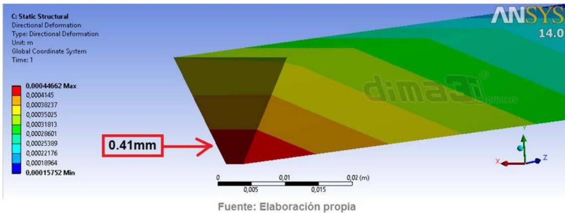
Figura 11: Deformación producida por el efecto de las tensiones internas en impresión con Dimafix® a 75°C
